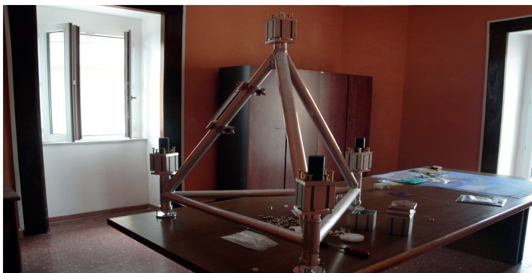
Fig. 1 – Gradiometro tensoriale a 12 componenti costituito da 4 terne magnetometriche triassiali.
