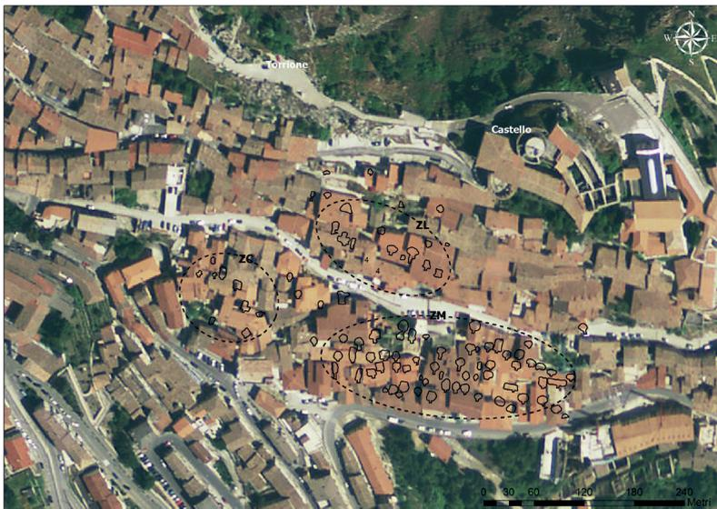
Fig. 2- Muro Lucano: sviluppo planimetrico delle cavità le cui ubicazioni sono riportate in Fig. 1.
