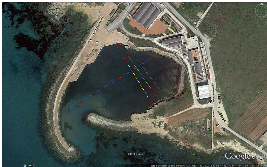
Fig. 2 – Immagine di Google Earth dell’area di Capo Granitola (TP) e localizzazione delle linee sismiche acquisite. Con i punti gialli sono rappresentati le posizioni degli idrofoni della linea n. 1, con i punti verdi quelli della linea n. 2 e con i punti rosa quelli della linea n. 3. Gli idrofoni del profilo n. 4, perpendicolare ai tre precedenti, è rappresentato dai punti blu. La posizione di tutti gli shot point eseguiti è raffigurata dai punti rossi.
