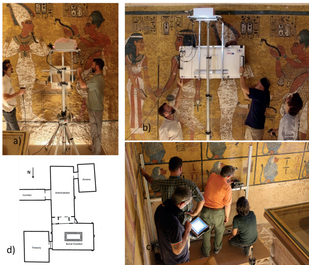
Fig. 1 - Acquisizione dati all'interno della KV62 (vista in pianta in d): a) bassa frequenza con antenna IDS RIS TR200 b) frequenza intermedia con un sistema IDS Stream-C multicanale a doppia polarizzazione e c) alta frequenza con antenna IDS Aladdin da 2 GHz a doppia polarizzazione. I profili di a) e di b) sono stati condotti verticalmente, i profili di c) orizzontalmente.
